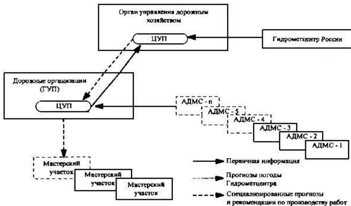
Рис.3.1. Примерная схема получения и передачи информации о погодных условиях на автодороге
